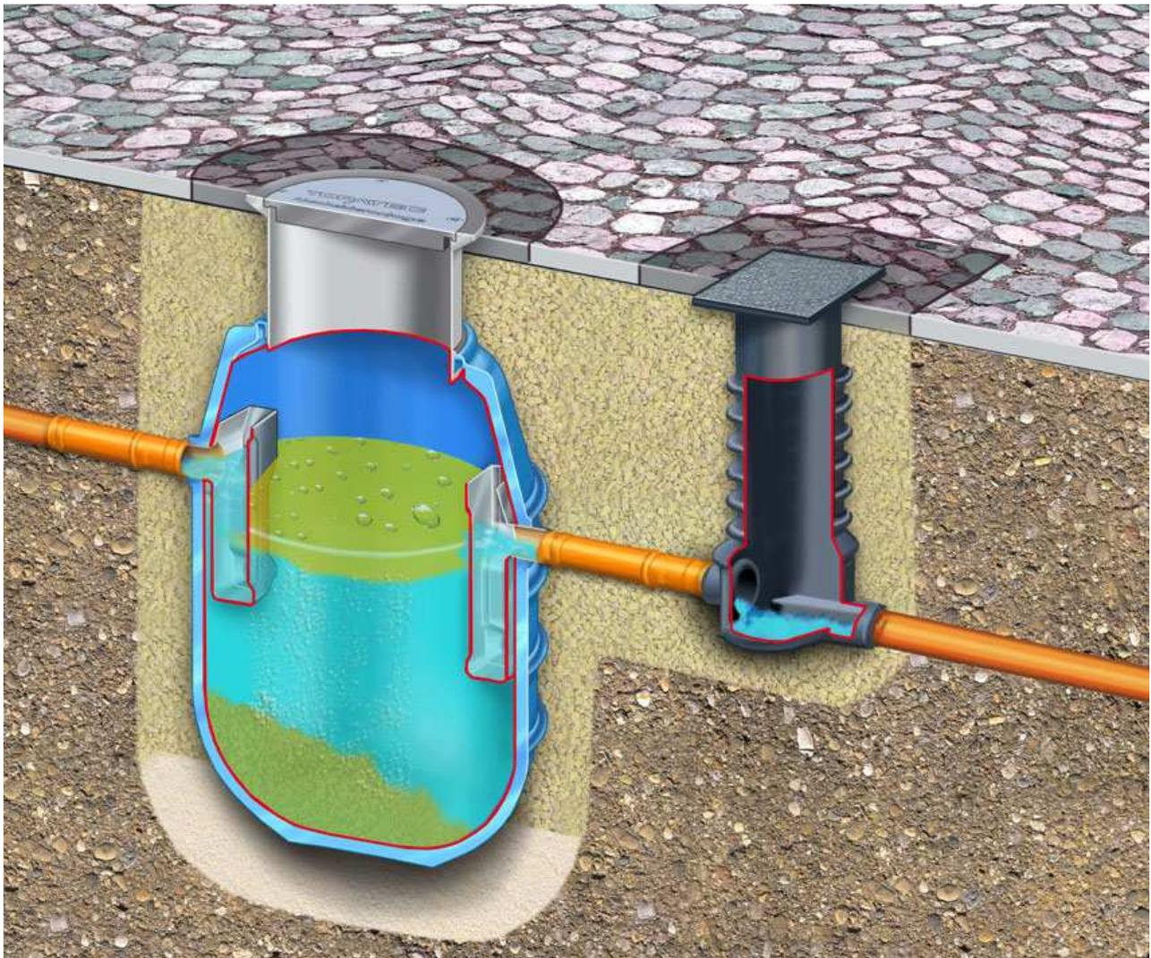
TOPATEC PE-Fettabscheideranlage AQUA-LIPOMASTER FE mit Probenahmeschacht
